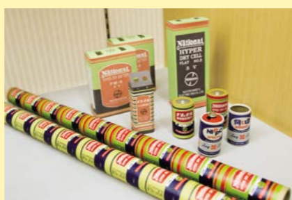
1930年ごろにつくられていた乾電池の外装用の手巻き筒と電池の紙箱
